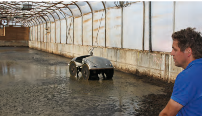
Karle überwacht die Trocknung der Gärreste
